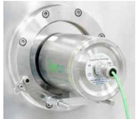
流動層の点検窓への取付
