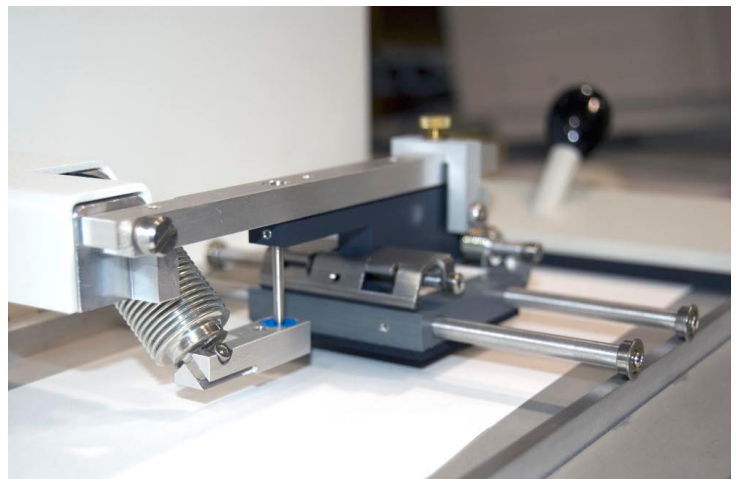
自動でスレッドを上下させるエレベーターシステム
