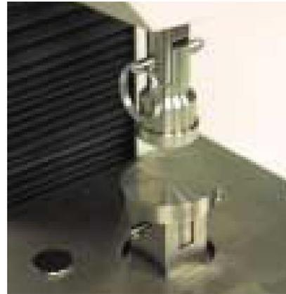
TMI 社 (米国製) Lab Master® ZDT は、分解能  $4.5g \pm 0.02\%$  において 113kg までの内部結合強度を測定する。表裏両側に両面テープを貼り付けた  $50mm \times 50mm$  のサンプルを測定部に取り付け、 $0.1\mu m$  単位でアームを Z 方向へ開き (位置再現性  $\pm 0.2\mu m$ ) 層間剥離するに要する荷重を測定する。最大剥離荷重、剥離距離データを計測。
