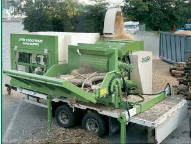
短い材料を使って作業中のPTH 1000/1000。ホッパー標準品に延長部をつなげることができます。油圧で持ち上げた状態でチェーンにスライドさせることによって、材料の投入が簡単にできます。
