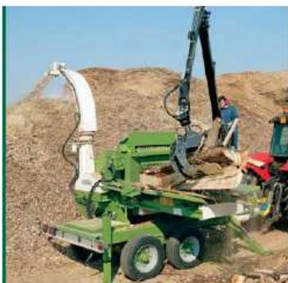
製材廃材を使って作業中のPTH 900/660。材料の投入を簡単にするために、下側油圧ローラーを追加装備することができます。
