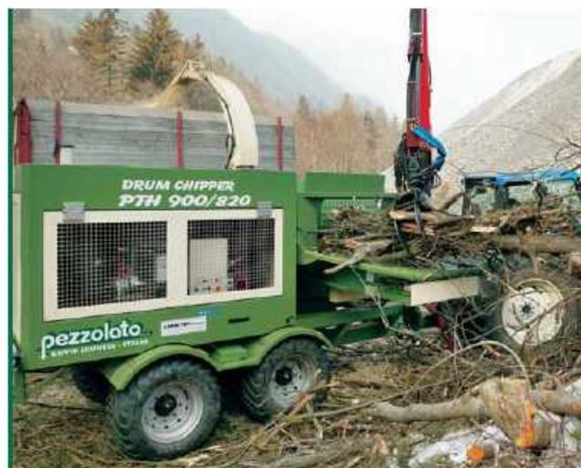
枝材を使って作業中の PTH 900/820。大容量のホッパーによって、大型材料または乱雑な材料の束も簡単に投入することができます。
