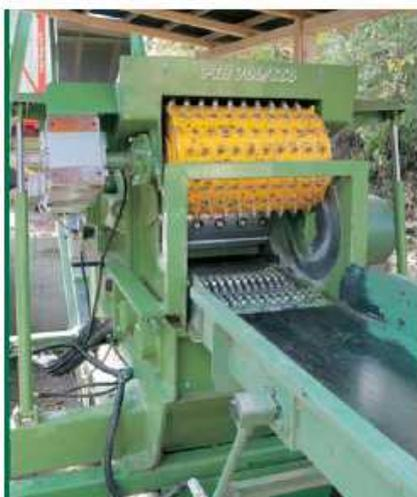
製材廃材の破碎用としてドラムと送り装置を搭載した PTH 700/660 の細部。
