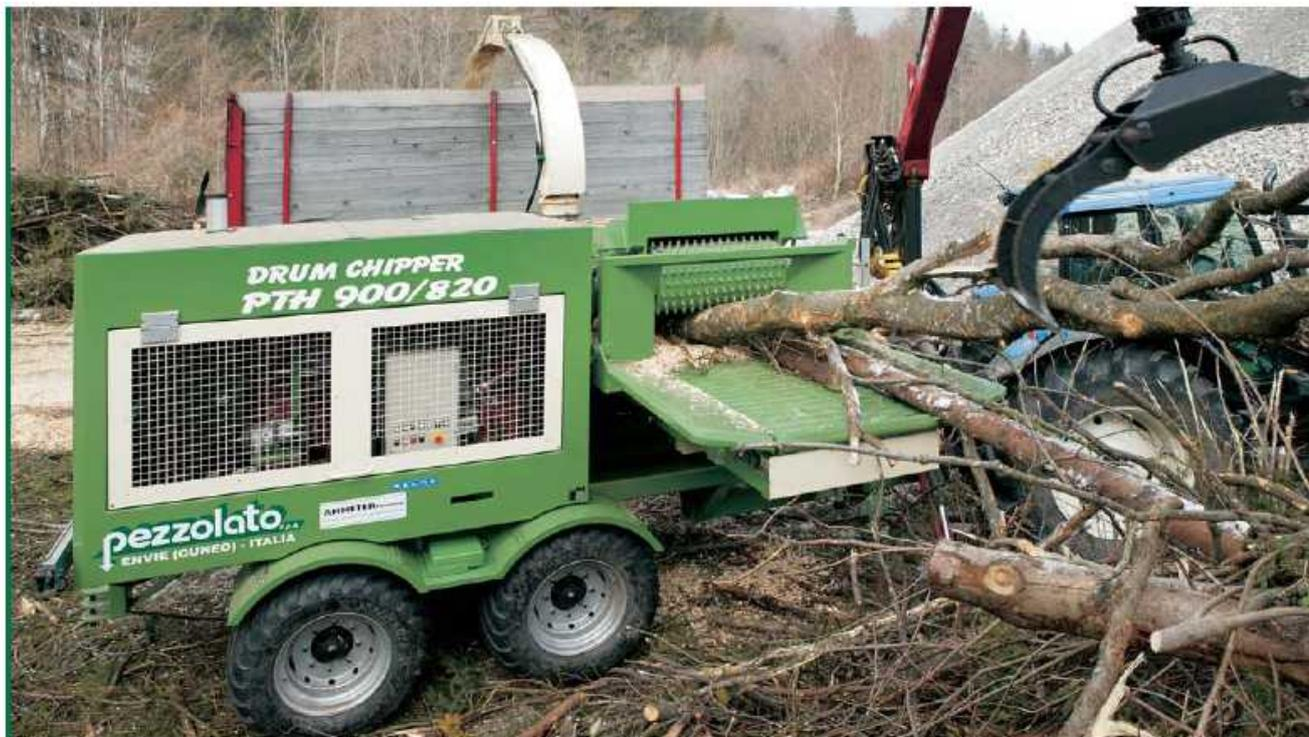
430 馬力のエンジンを搭載して作業中の PTH 900/820。（全体がカバーで覆われている）エンジンブロックには、開閉位置の保守点検ができるようにガススプリングヒンジのついた点検用のサイドドアが 2 つあります。
