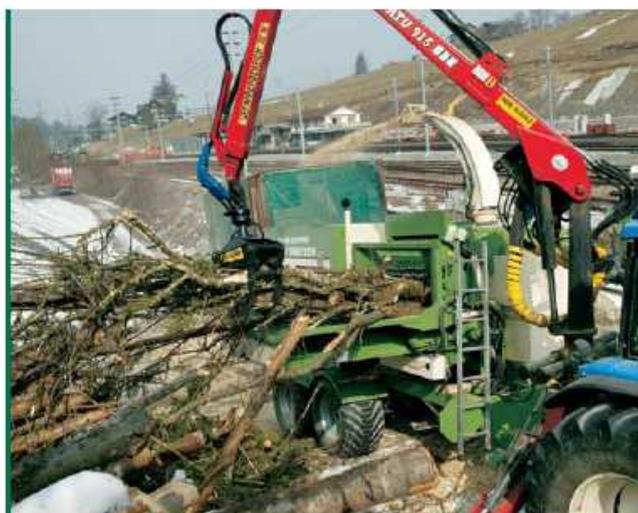
様々に異なる大きさの丸太材を使って作業中の PTH 900/820。作業員は、クレーンについている制御装置を作動させるか、または無線制御装置を使って上側送りローラーの高さを上げることができるので、作業がより簡単になります。
