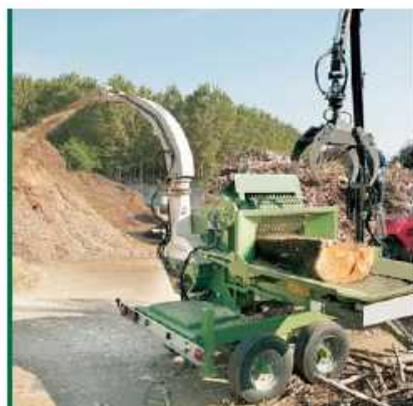
著しく大きな直径(最大40 cm)の丸太材を使って作業中のPTH 900/660。
