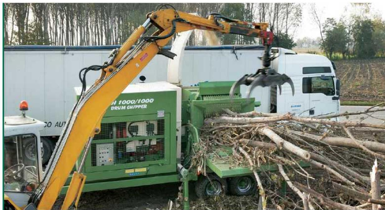
作業中の PTH 1000/1000。開閉位置の保守点検ができるように、(全体がカバーで覆われている) エンジンブロックにはガススプリングヒンジのついた点検用のサイドドアが 2 つあります。
