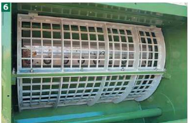
標準仕様品または角目ふるいをつけた製品は、破砕チップをふるいにかけるグリッドを取り付けることによって精緻なフィード検量を実現しています。このグリッドは耐摩耗性のある材料で作られており、取り付けや取り外しが簡単にできるように手が届きやすく設計されています。
