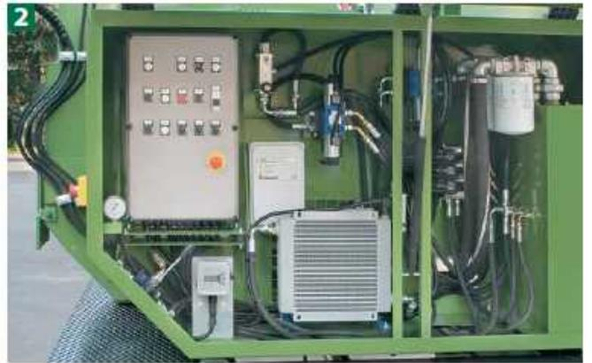
ドラムチッパーフードの上を開くとナイフの交換がより簡単にできます。機械の制御装置は手が届きやすいカバーによって保護されており、日常の保守作業がより簡単にできます。
